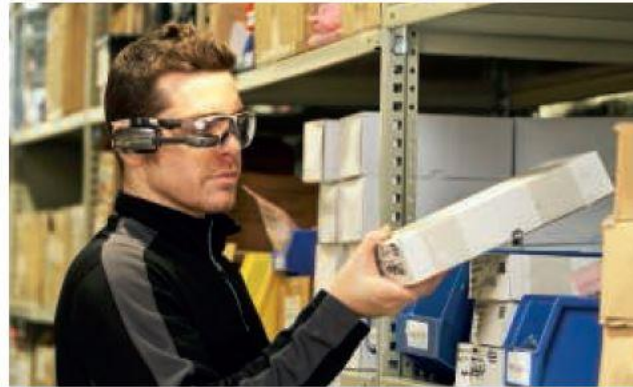
Schnelle Arbeit: Die Software X-Pick führt einen Kommissionierer mit Vuzix-Datenbrille.
