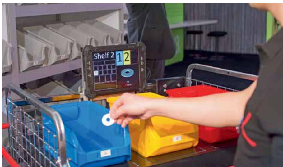
Bild 2: Die mobile Variante der Datenbrille xPick mit Tablet-PC und Plausibilitätswiegemodul.
