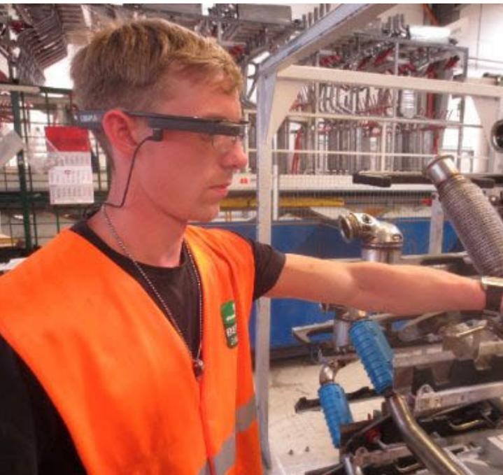
Der Schnellecke-Mitarbeiter nutzt die Dateninformation von xPick für das sequenzgerechte Verpacken der Abgasanlagen.
